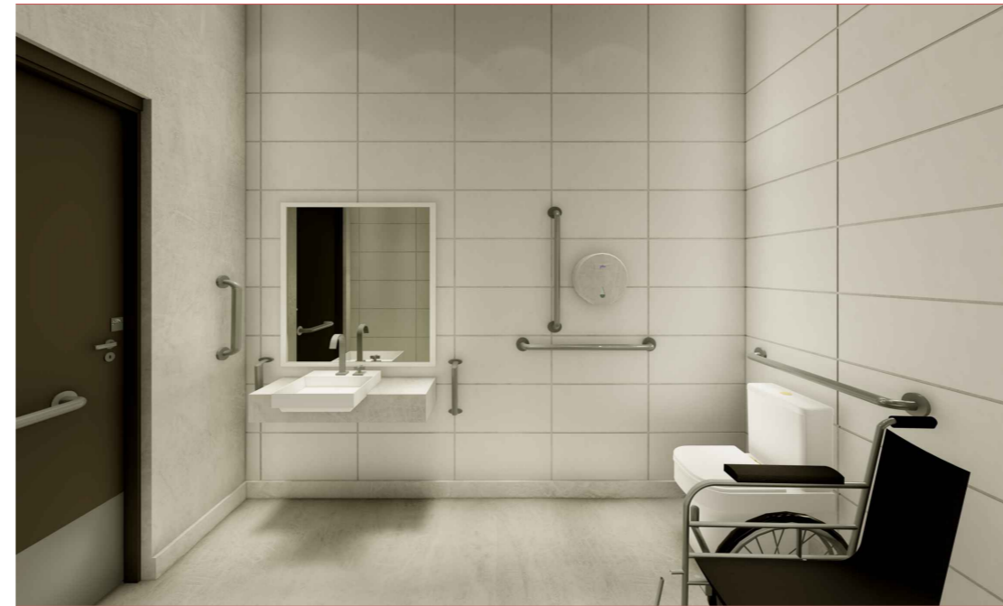
Detalhamento banheiro PNE ESC.S/ ESCALA
