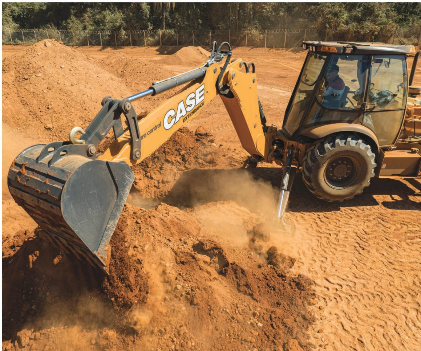
A **580N Series 2 HD** e a **580N Series 2** são equipadas com uma nova bomba hidráulica, entregando maior velocidade nas operações e nas respostas dos comandos. A bomba hidráulica tem alta confiabilidade e potência de sobra para as operações mais severas e frequentes. As mangueiras e tubulações conduzidas por dentro da estrutura da lança proporcionam maior proteção.
